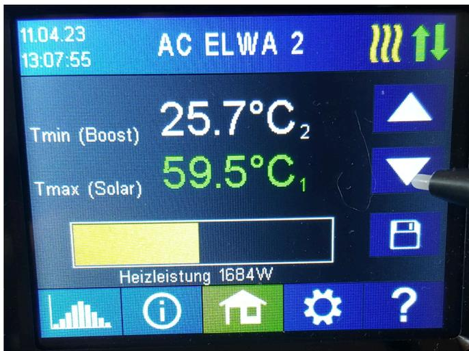
Um die Zieltemperatur für Heizen mit PV-Überschuss einzustellen, tippen Sie auf die untere Temperaturanzeige Tmax (Solar) und verwenden die Pfeiltasten rauf und runter am rechten Bildschirmrand. Danach speichern Sie die Einstellungen mit dem Button darunter.
